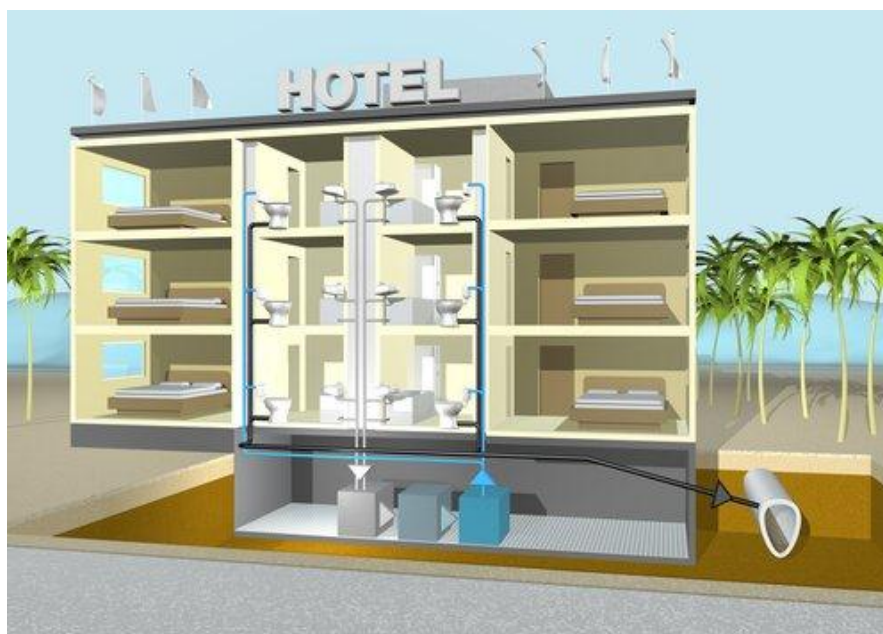
Figura 3 - Exemplo hipotético de sistema de reuso de água 4
