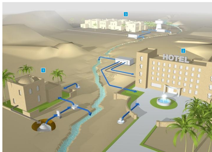
Figura 2 - Reuso indireto de águas residuárias 3
